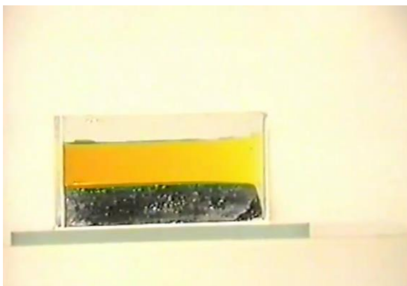
2.2.3-chizma. Ho'llash va ho'llanmaslik hodisasiga oid tajriba.
