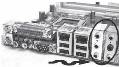
6.2-rasm. Tizimli plataga joylashtirilgan tovush adapterining audio razyomlari.
