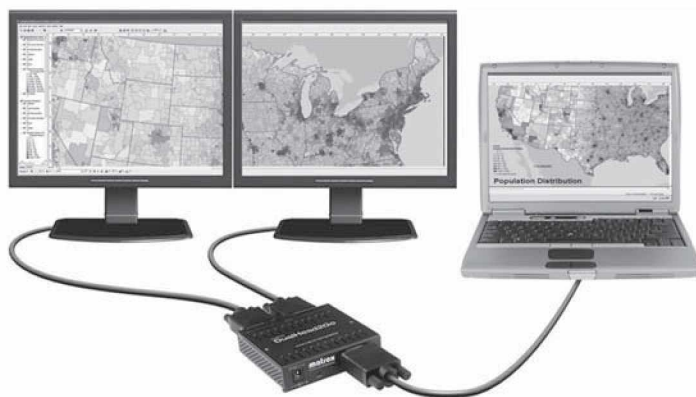
7.7-rasm. Bitta dasturni bir necha monitorning ekranida aks ettirish uchun mo'ljallangan Matrox DualHead2Go qurilmasidan foydalanish.
