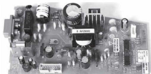
4.15-rasm. Skanerning elektr ta'minot bloki o'rnatilgan plata.
