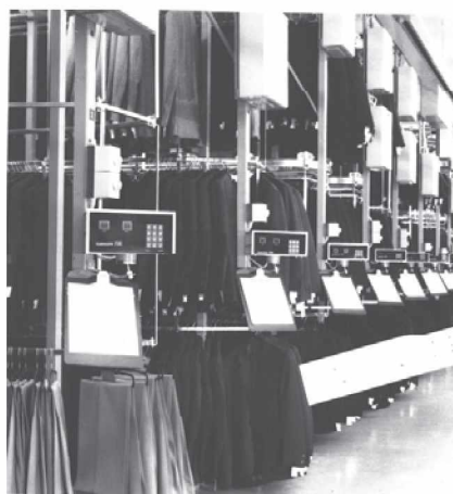
111-rasm. Elektron boshqaruvli avtomatlashtirilgan tayyor mahsulotlar ombori.
