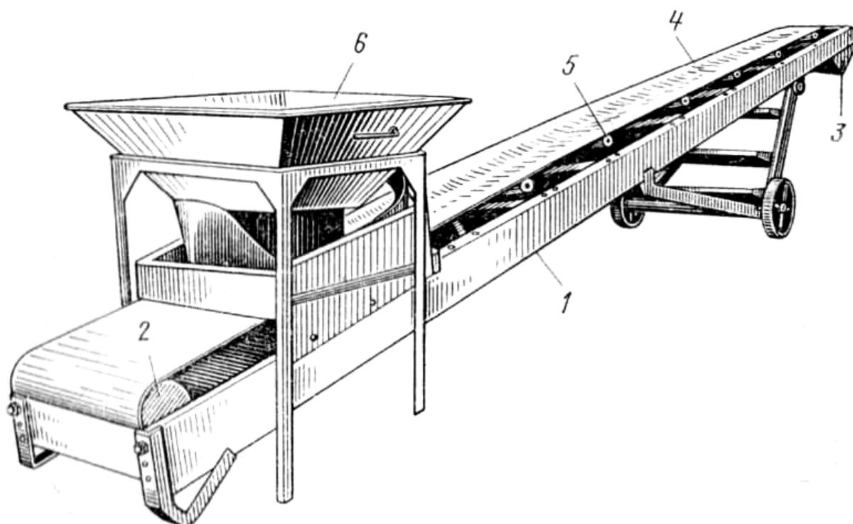
Рис. 4. Ленточный передвижной конвейер
