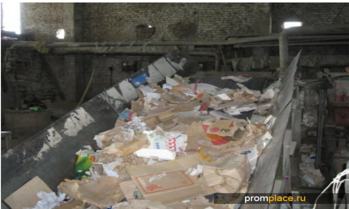
После сортировочной линии, где бумага отделяется от лишних материалов, она пакетируется с помощью пресса для отходов. На заводе по переработке бумаги спрессованные кипы подвергаются вымачиванию в специальных резервуарах-гидроразбивателях, которые являются важнейшим оборудованием. Сам процесс вымачивания называется роспуском макулатуры. Добавление во время вымачивания различных веществ позволяет добиться того, что бы частицы типографской краски и чернил больше не прилипали к волокнам.
