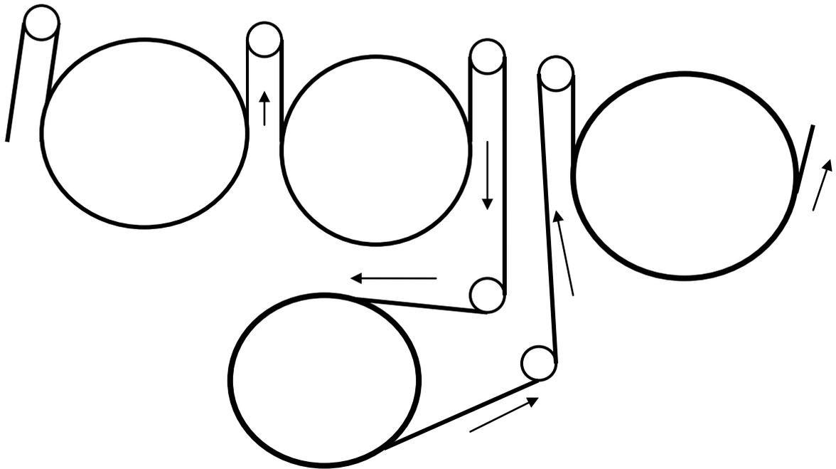
**Рис. 2.** Схема расположения сукносушителя в прямой ветве сушильной группы
