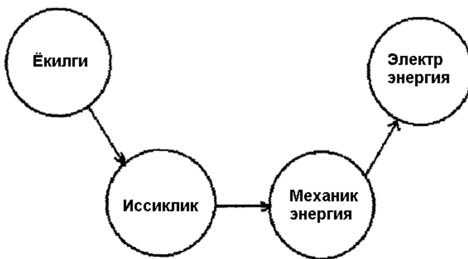
1.2 – расм. Иссиқлик электр станцияларда энергияни қайта ҳосил қилиш схемаси.
