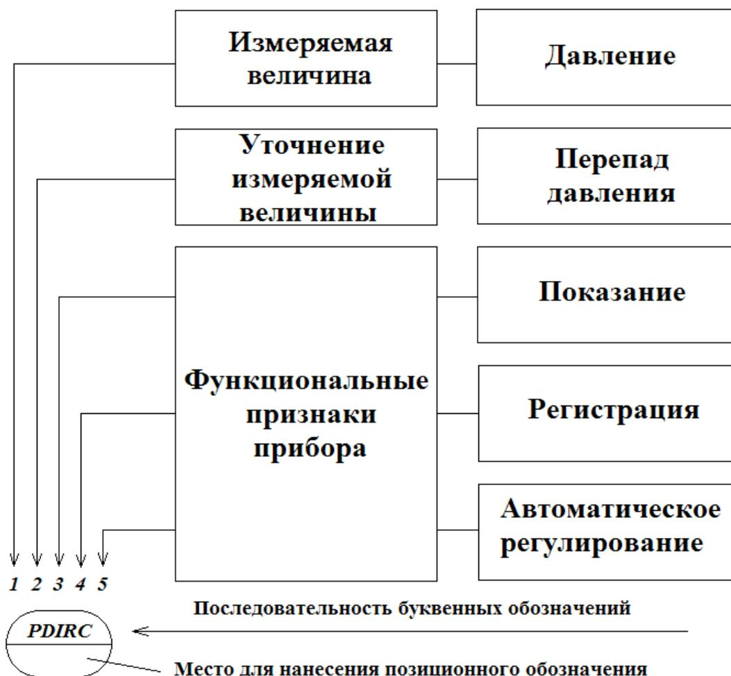
Рис. 5.1. Пример построения условного обозначения прибора для измерения, регистрации и автоматического регулирования перепада давления.
