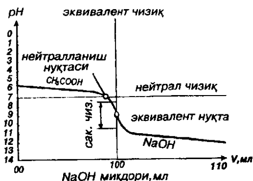
37-расм. \text{CH}_3\text{COOH} нинг 0,1 н эритмасини \text{NaOH} нинг 0,1 н эритмаси билан титрлаш эгри чизиги
