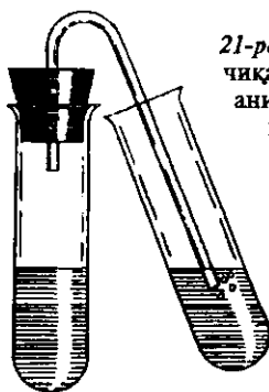
20-расм. Реакцияда ҳосил бўладиган газларни аниқлаш асбоби.
