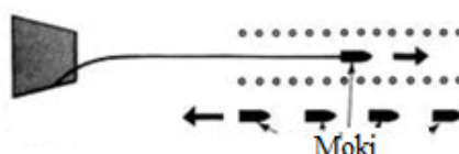
3.3-rasm.Mitti mokili arqoq tashlash printsiipi
