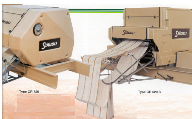
2.50-rasm. Ikki ko'tarimli, bir tsilindrli jakkard mashinasini ko'rinishi
