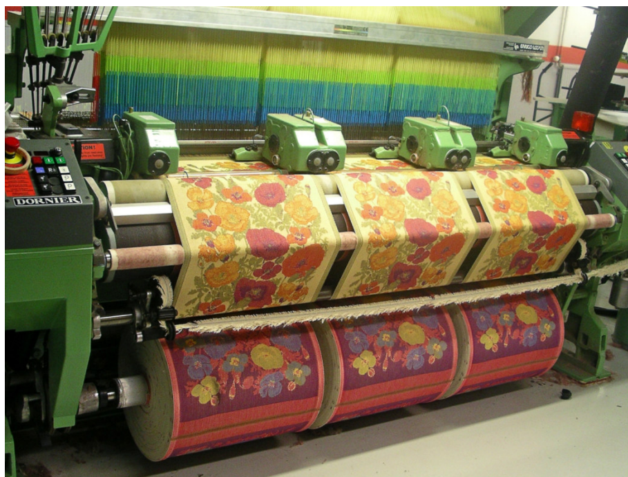
2.39-rasm. Jakkard mashinasida xomuza va naqsh hosil qilish.
