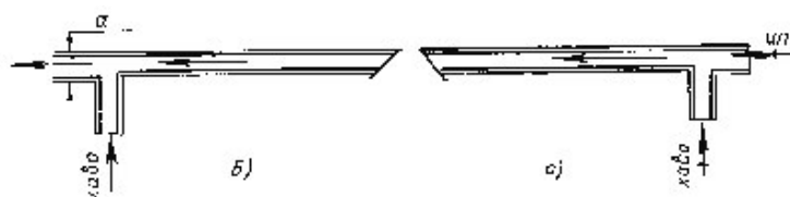
3.45-rasm. O'lchovchi moslamadan arqoq ipining o'tishi
