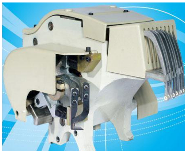
7.6-rasm. Sulzer Textil G6200 rapirali to'quv dastgohida turli arqoq iplari bilan ta'minlash tizimi
