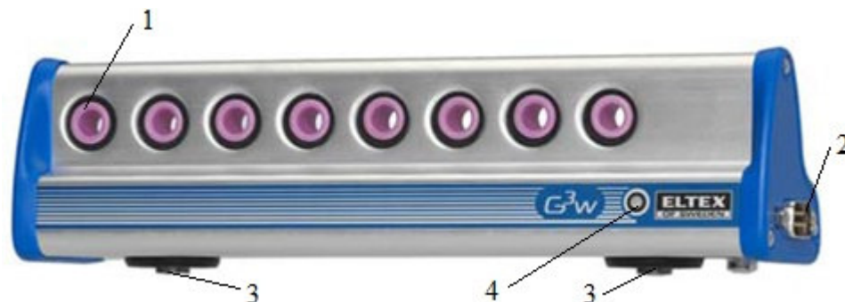
8.10-rasm. "ELTEX G3w" elektron arqoq nazoratchisi 1-arqoq ipi o'tuvchi ko'zchalar, 2-ulash uychasi, 3-mahkamlash joyi, 4-indikator (yashil lampochka)
