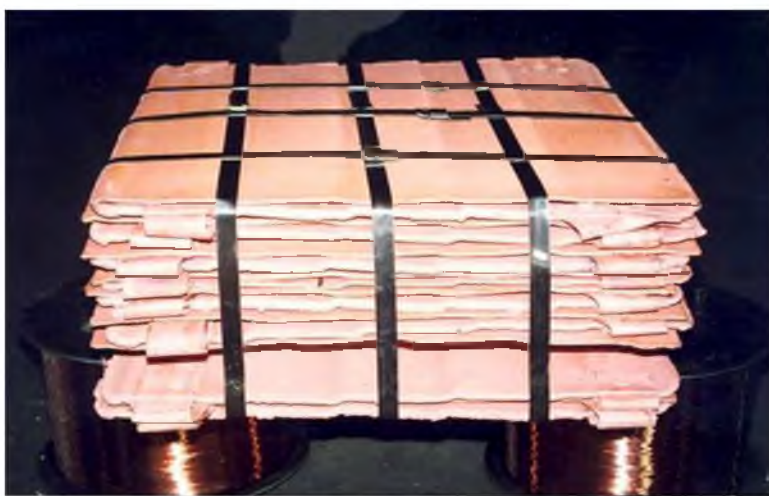
1- rasm. Elektroliz sexidan chiqqan va sotuvga tayyorlanga 99,99 % li mahsulot – mis katodining umumiy ko'rinishi.
