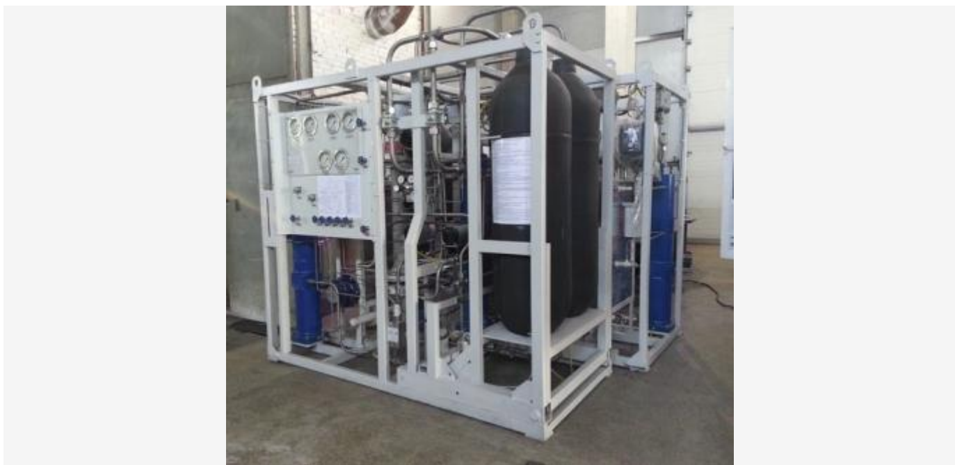
3.2-расм. Блок-бокс юқори босим газининг компрессор ва қуритиш қурилмаларини.
