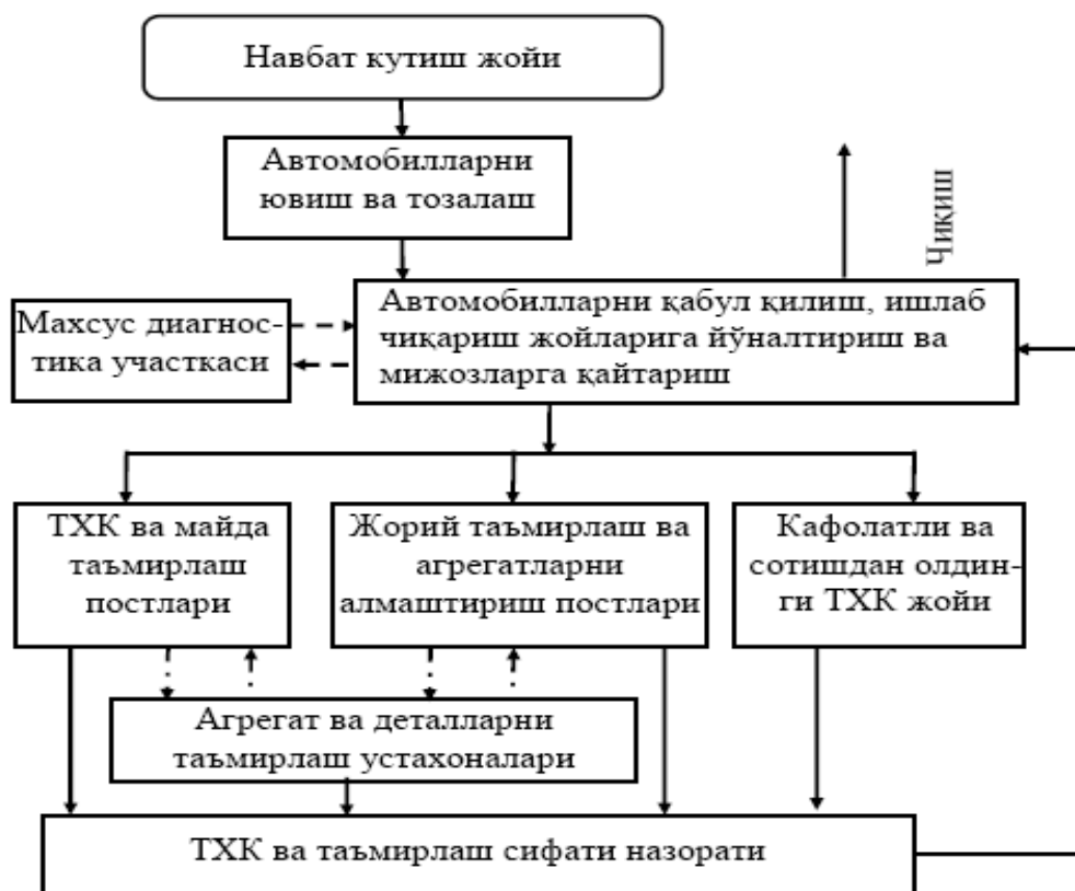
4.1-расм. АСКларида автосервисни ташкил қилишнинг технологик жараёни.
