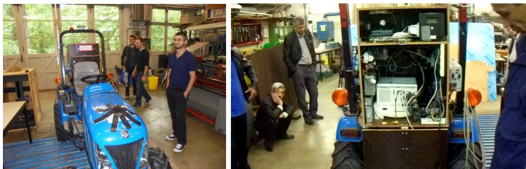
1.7 rasm. Lyoven Katalok Universitetida yaratilgan pilotsiz traktor
