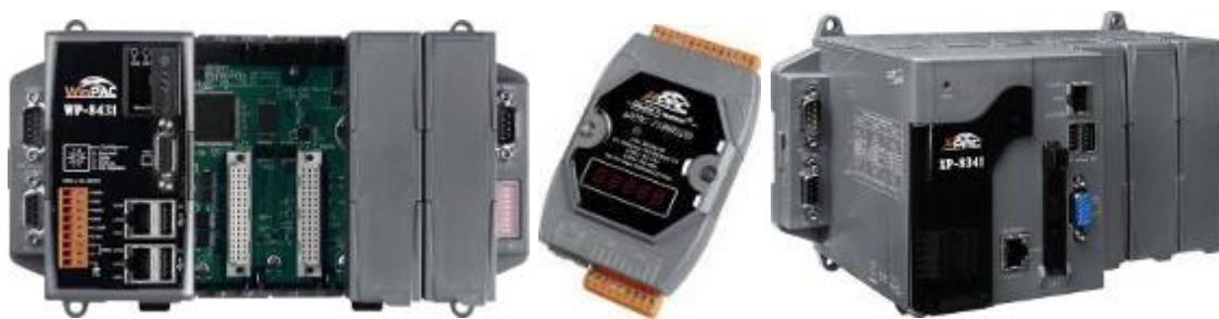
3.1-расм. WinCon, uPAC, XPAC контроллерларининг ташқи кўриниши
