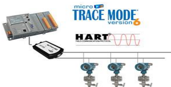
3.3- расм. HART Master протоколи драйверининг WinCon 8000 контроллерини HART-модем ёки мультимплексорлар билан уланиши схемаси
