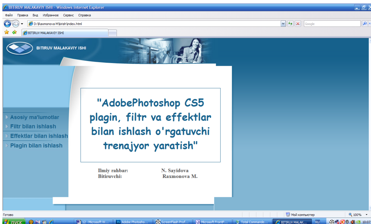
2.26- chizma . Dasturning bosh sahifasi. To'rtta bo'limdan iborat. 1- asosiy ma'lumotlar, 2- filtr bilan ishlash, 3- effektlar bilan ishlash, 4- plugin bilan ishlash.
