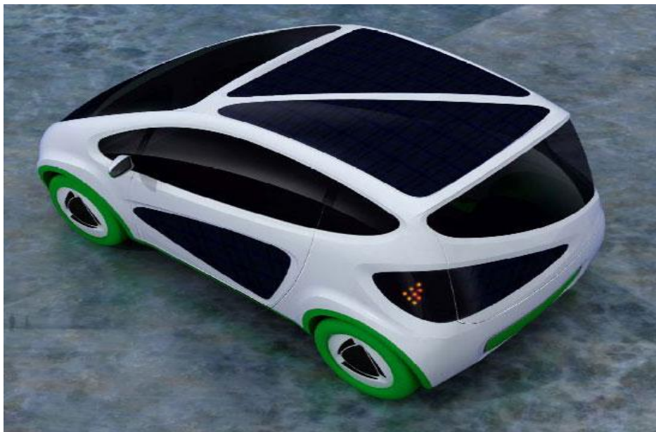
5.4– rasm. Tomiga o`rnatilgan quyosh batareualari yordamida akkumulyator batareyalarini zaryadlovchi shahar ichida yurishga mo`ljallangan elektromobil .
