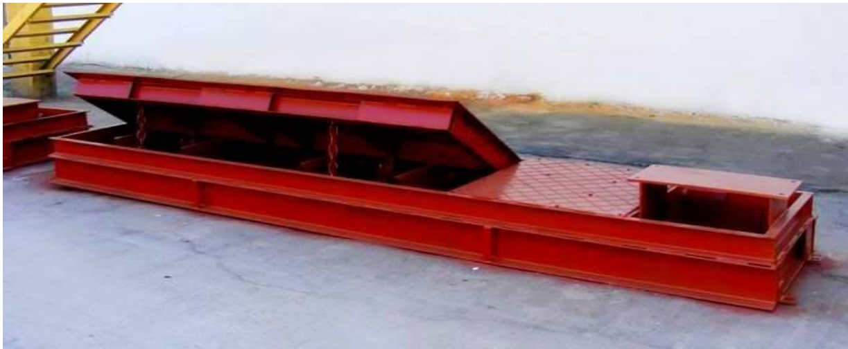
Pereezdlar to'sish qurilmasi (UZP)
