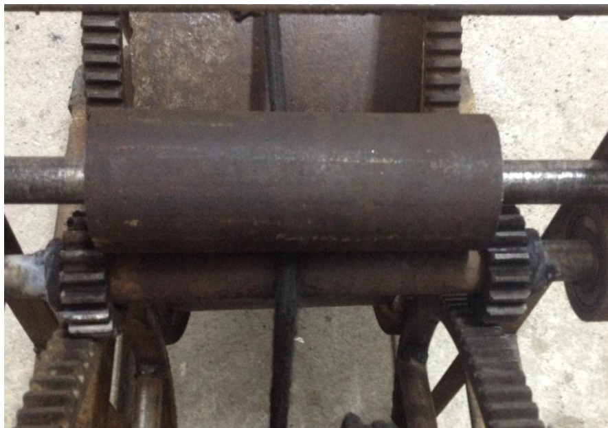
2.17-rasm. Shamol generatorini tezligini rostlash uchun taklif etilayotgan konstruksiya
