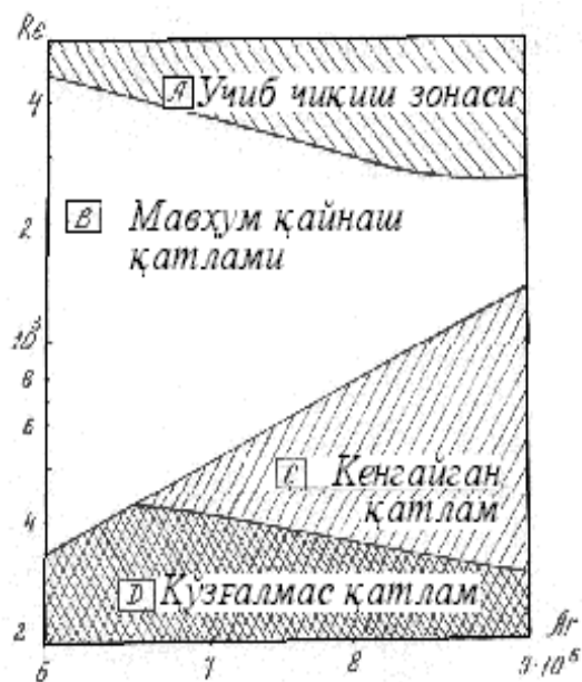
7-расм. Донадор - толали материалларнинг қўзғалмас, кенгайган ва мавҳум қайнаш қатлам ҳолатларининг мавжуд бўлиш чегаралари.
