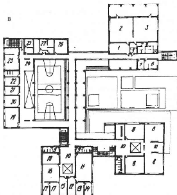
Рис. 14.4. Детские ясли – сад на 50 мест, кооперированные с малокомплектной школой на 108 учащихся (проект): в – план 2 – этажа: 1 – раздевальная; 2 – групповая; 3 – спальня; 4 – туалетная; 5 – буфетная; 6 – гостирочная; 7 – кладовая чистого белья; 8 – кабинет старших классов; 9 – санузел; 10 – холл – рекреация; 11, 15 – лаборантские; 12 – лаборатория физики; 13 – лаборатория химии; 14 – лаборатория биологии; 16 – класс пеших; 17 – инвентарная; 18 – комната юншатов; 19 – учительская; 20 – кабинет директора; 21 – канцелярия; 22 – кабинет завуча; 23 – библиотека; 24 – технический центр; 25 – фотолаборатория; 26 – медицинская комната; 27 – изолятор
