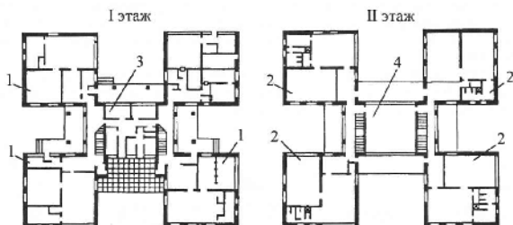
Рис. 3.8. Планы здания детского дошкольного учреждения на 160 мест: 1 – помещения ясельных групп; 2 – то же, детского сада; 3 – административно – хозяйственные помещения; 4
