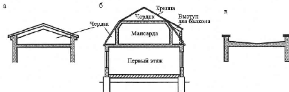
Рис. 20.2. Схемы основных типов крыш: а - чердачная, б - мансардная, в - бесчердачная
