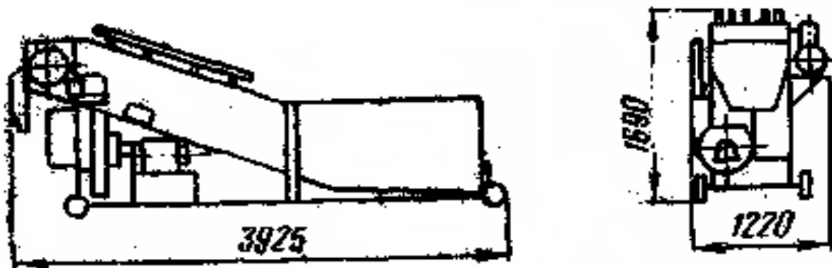
25-rasm. Ventilyatorli yuvish mashinasi.
