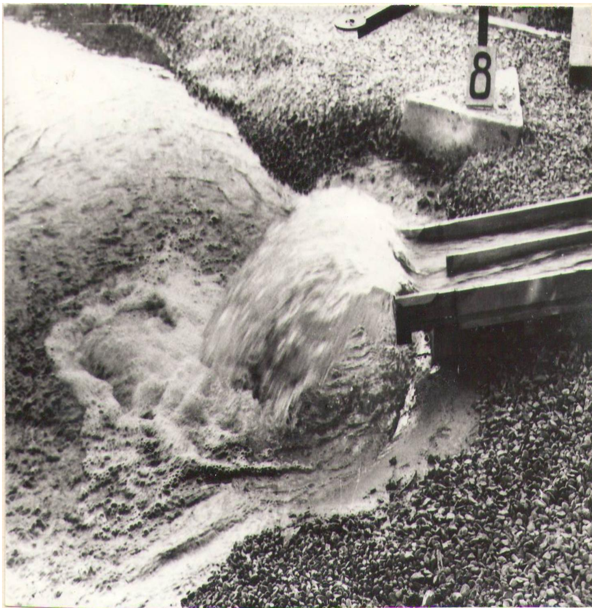
4.1 – РАСМ. ИНШОТНИНГ ЭТАК ҚИСМИ МОДЕЛИ (ЦИЛИНДРСИМОН ТЕШИКСИЗ ТРАМПЛИН) б) СУВ БИЛАН Q_{СБР}= 90 \text{ M}^3/\text{C} ,
