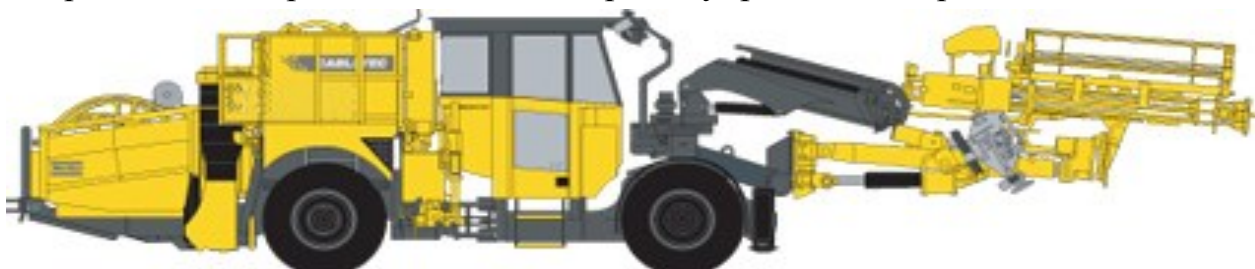
Рис. 4 Комплекс тросового анкерования "CabletecL" Атлас Копко. Габаритные размеры: ширина - 2 700 мм; высота кабины - 2 900 мм (низкий вариант) ÷ 3 350 мм (высокий вариант); длина - 14040 мм; масса - 28 000 кг
