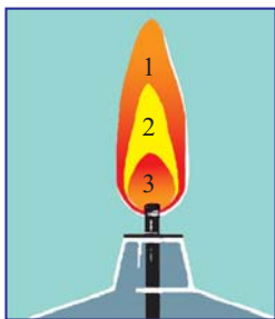
5-сүрөт. Спиртовка жалынынын түзүлүшү
