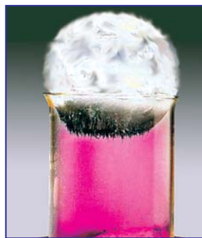
9-сүрөт. Йод бөлүкчөлөрүнүн муздак бетте чогулуп, йод затын пайда кылышы
