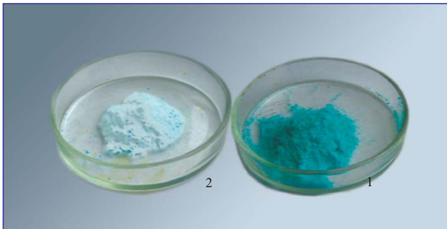
48-сүрөт. Туздардын үлгүлөрү: жез сульфаты \text{FeSO}_4 (1) жана кристаллдашкан сууну кармаган жездин купоросу \text{CuSO}_4 \cdot 5\text{H}_2\text{O} (2).
