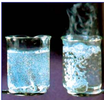
33-сүрөт. Цинктин түрдүү концентрациядагы сульфат кислотасы менен таасирдешүүсү
