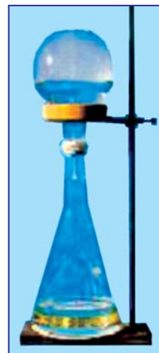
47-сүрөт. \text{HCl} газынын сууда эрип, хлорид кислотасынын эритмесин пайда кылышы
