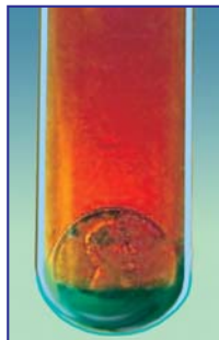
43-сүрөт. Жездин жана башка металлдардын ар түрдүү кислоталар менен таасирдешүүсү
