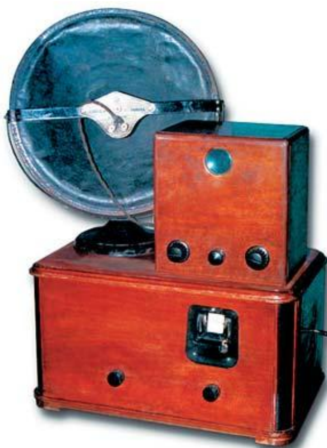
Расм 1.2 Бэрднинг дискли ТВ камераси ва электромеханик телевизор қурилмаси.
