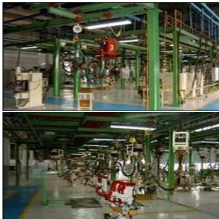
4-расм: Матиз автомобилни олди чап ва ўнг тиргагичлар йиғув цехи
