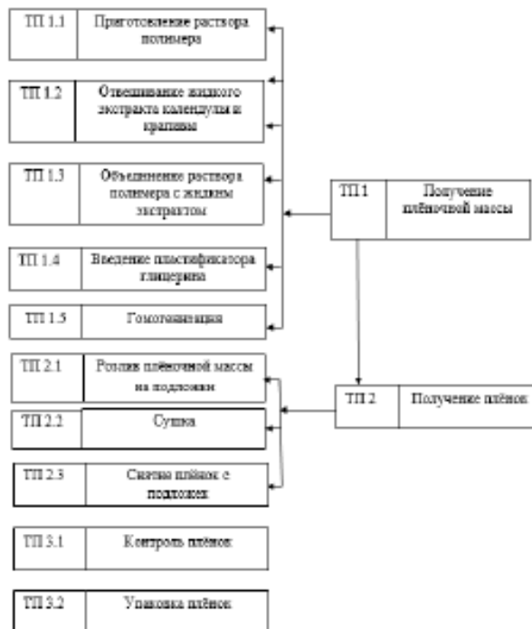
Рис. 1. Схема технологического процесса получения лекарственных плёнок с жидким экстрактом календулы и крапивы
