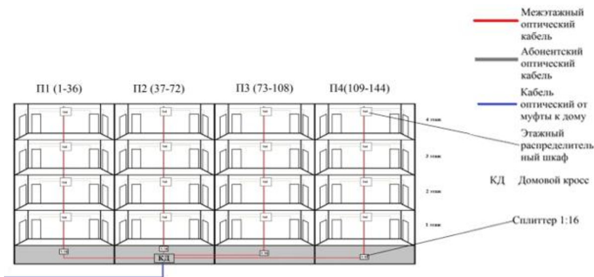
Рисунок 2.5. Домовая распределительная сеть FTTH
