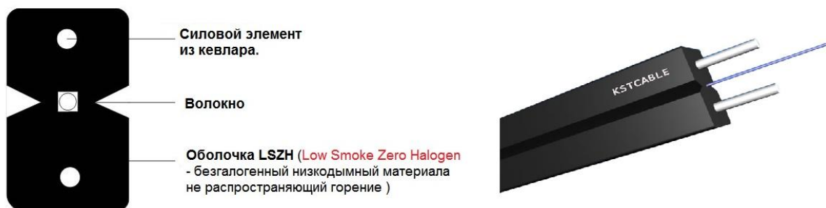
Рис.2.13. Оптический кабель FTTH 1 Core
