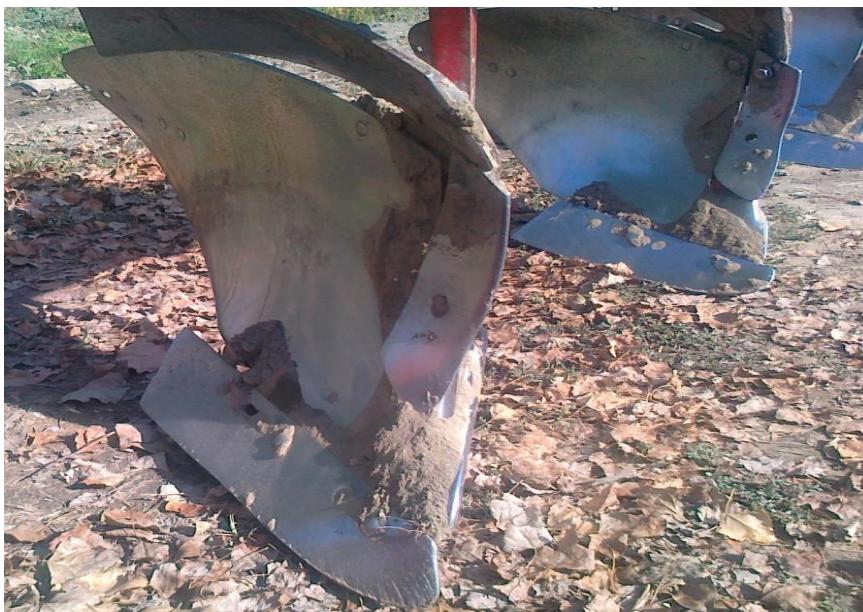
1-расм. Ейилиб ярқсиз холга келган омоч лемехи ва ағдаргичининг ҳолати
