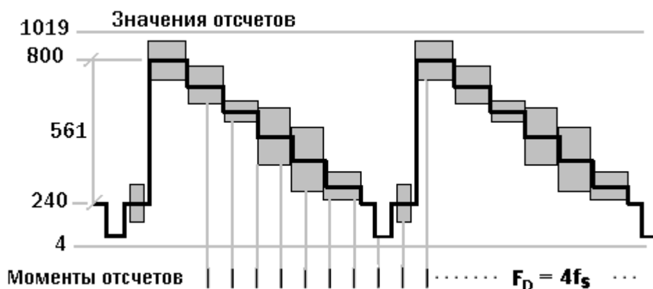
Рис.2.14. Композитное представление ТВ сигнала системы SECAM
