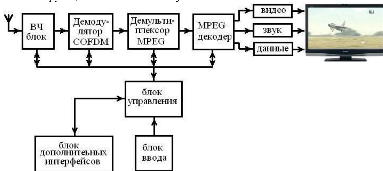
Рис.8.4. Структурная схема декодирования сигнала DVB-T.
