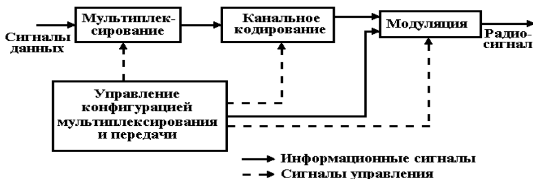
Рис.6.22. Схема передачи ISDB-T
