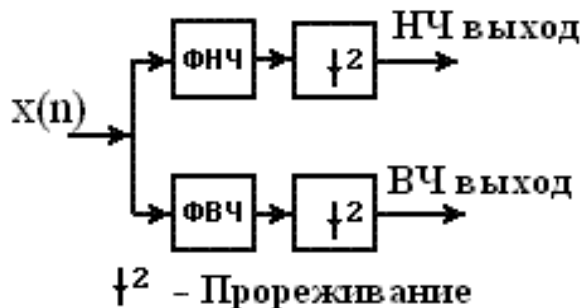
Рис.4.5. Схема работы частотного фильтра
