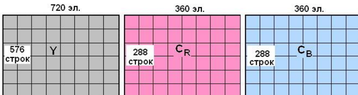
Рис. 2.11. Кодирование компонентного видеосигнала в формате 4:2:0.
