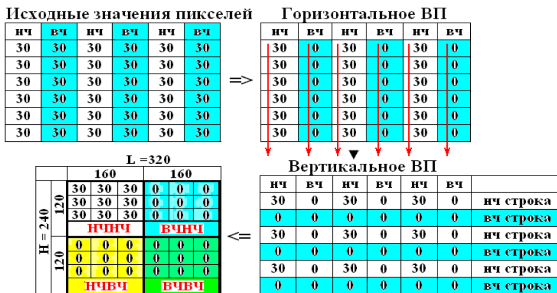
Рис.3.14. Результаты двумерного ВП тестового изображения размером 320 \times 240 со значением яркостного сигнала Y=30
