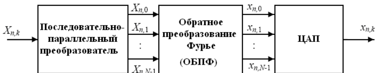
Рис.5.9. Принцип формирования OFDM сигнала.
