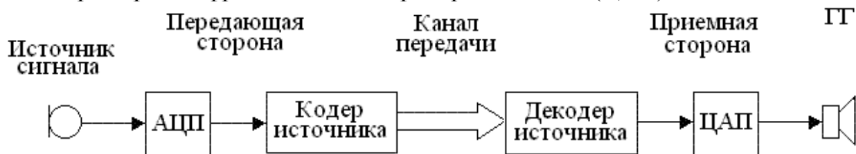
Рис.3.33. Обобщенная схема передающей и приёмной частей цифровой системы передачи звуковых сигналов
