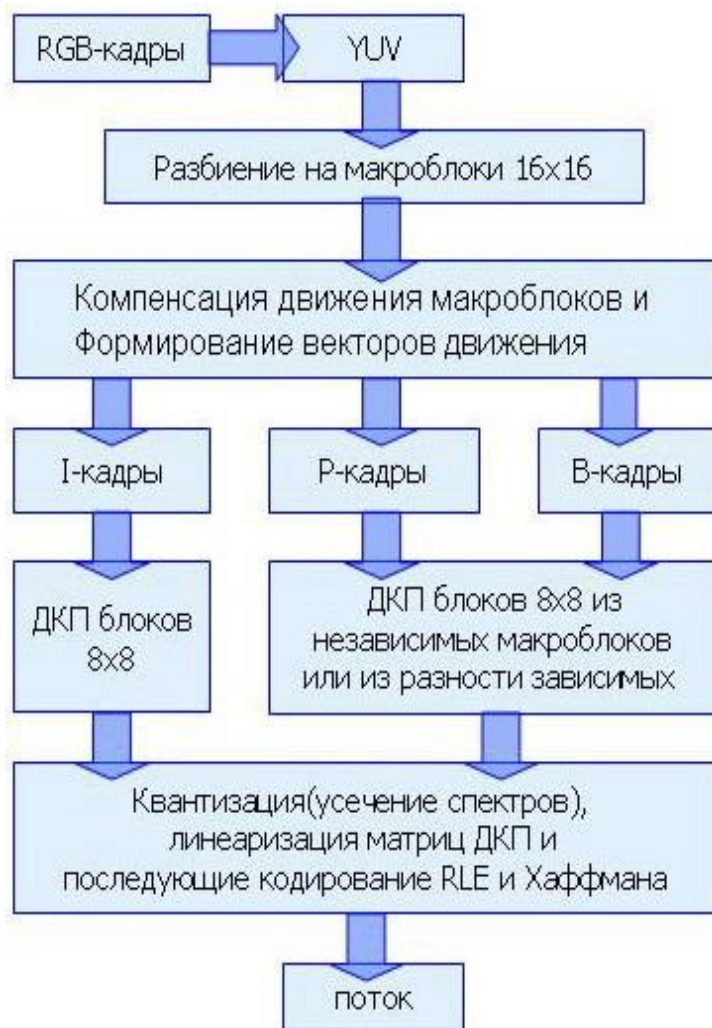
Рис.4.11. Алгоритм сжатия видео в стандарте MPEG-1
