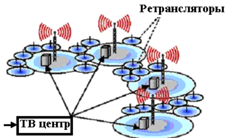
Рис.6.16. Вариант одночастотной сети DVB-H
