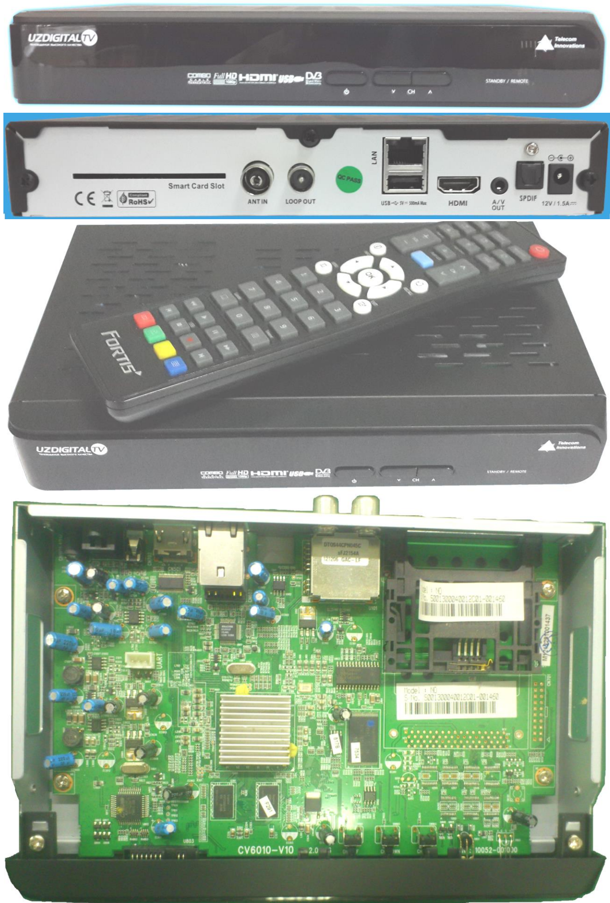
Рис.8.3. Тюнер TE-6010IR (вид спереди, сзади, сверху и внутри)
