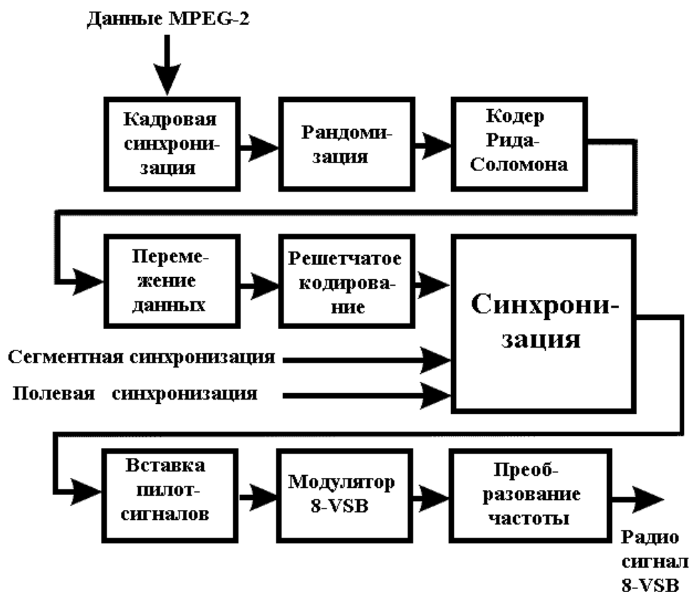
Рис.6.19. Структура передающей части системы ATSC
