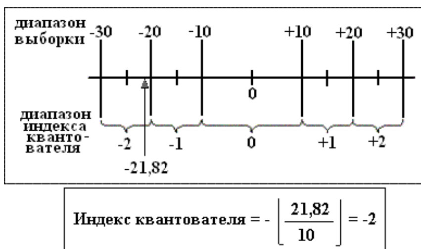
Рис.4.7. Пример работы квантователя
