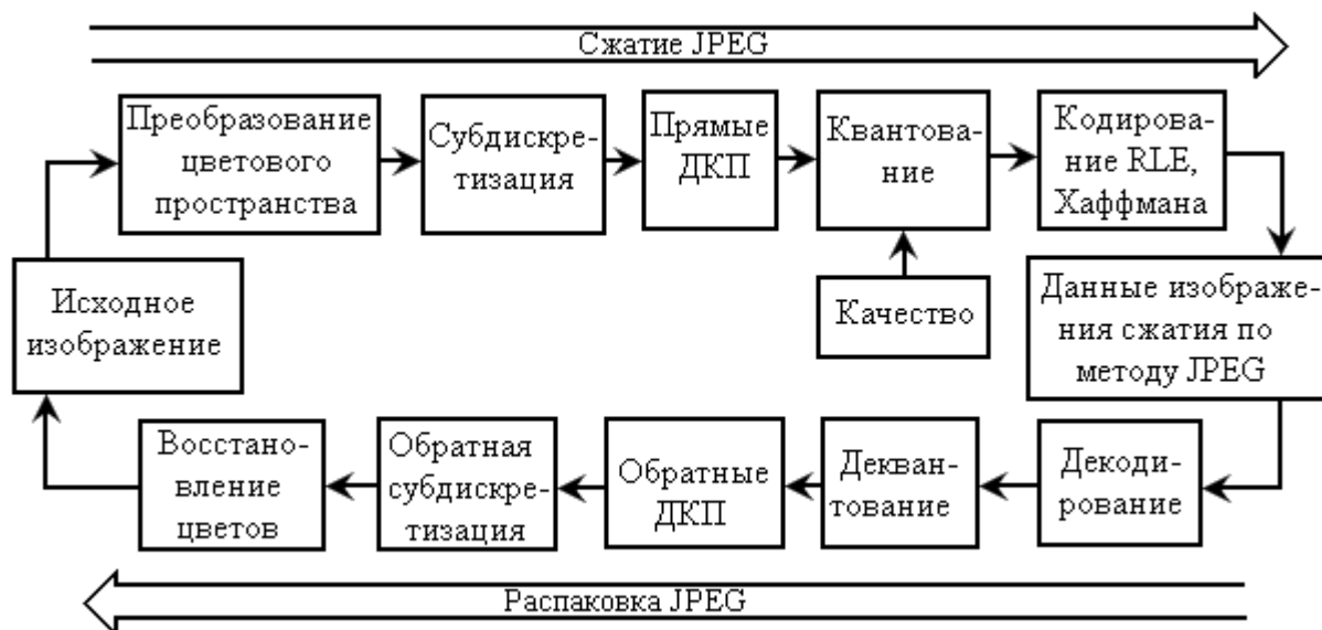
Рис.4.1. Структурная схема кодирования и декодирования изображений по стандарту JPEG
