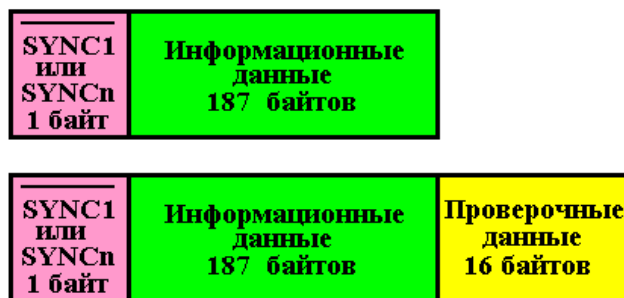
Рис.6.4. Формирование пакетов данных с защитой от ошибок с памятью внешнего кода Рида-Соломона RS (204, 188)
