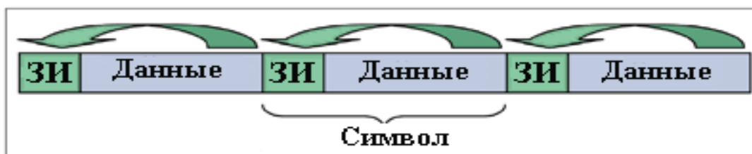
Рис.7.7. Использование защитных интервалов
