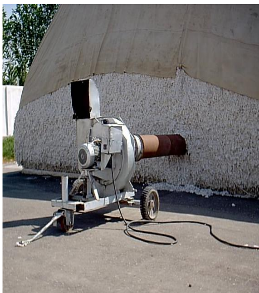
9-rasm. UVP rusumli kochma ventilyatorning g'aramga o'rnatilishi va qurilmaning tuzilishi. 1-markazdan qochuvchi ventilyator; 2-havoni chiqarish quvuri; 3-koziyok; 4-drossel qopqog'i; 5-havo tortish tog'ri quvuri; 6-g'ildiraklar (bitta aylanuvchi va ikkita tayanch); 7-elektr dvigatel ; 8-elektr tosiq.
