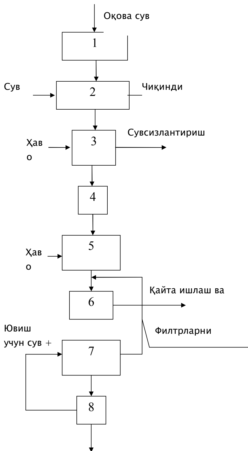
2-расм. Саноат оқова сувларини механик тозалаш схемаси
