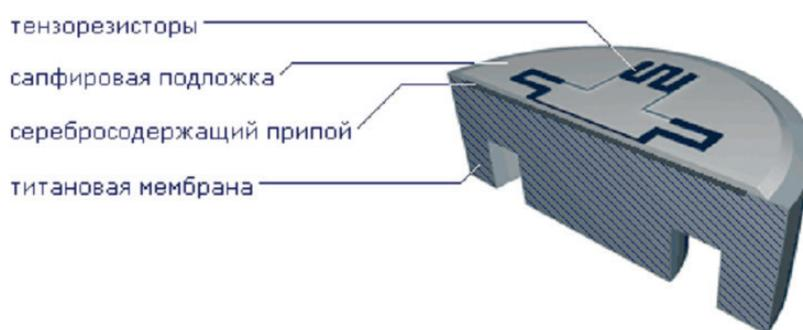
Рис. 1. Упрощенный вид тензорезистивного чувствительного элемента
