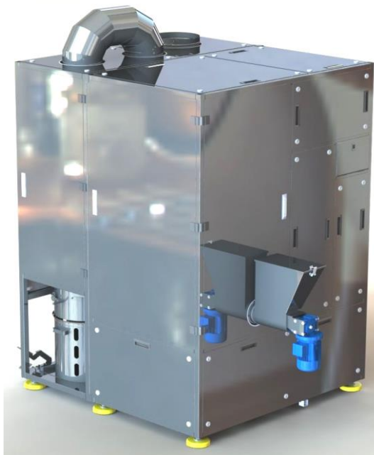
Рис. 2. Установка «ЮВЕТ 005» порошкова активаційна сушильно-подрібнювальна для сушіння або досушування сировини до 6-10 % вологості та подрібнення її до порошкоподібної маси преміум-класу
