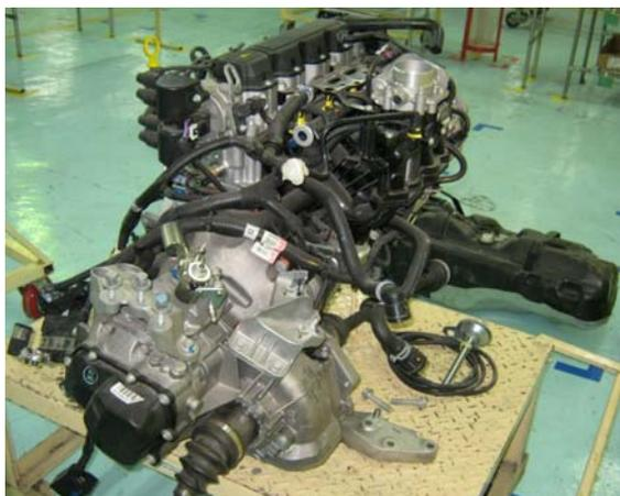
**Рис.9. Интегрируемый силовой агрегат L2C для дорожных испытаний**
