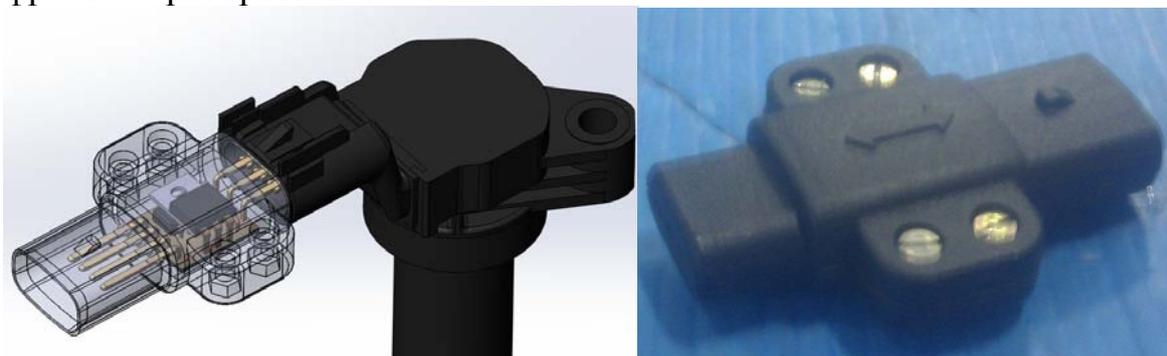
**Рис.5. Мехатронный адаптер катушки зажигания**
