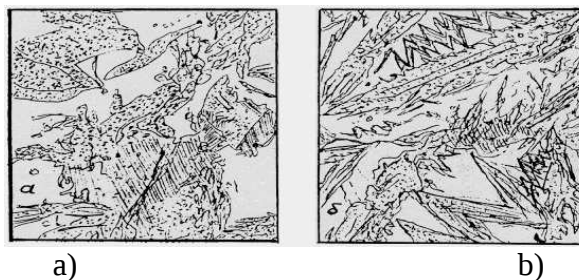
24- su`wret. Plastinka (a) va tayoqsha (b) formadagi martensitin` mikrodu`zilisi
