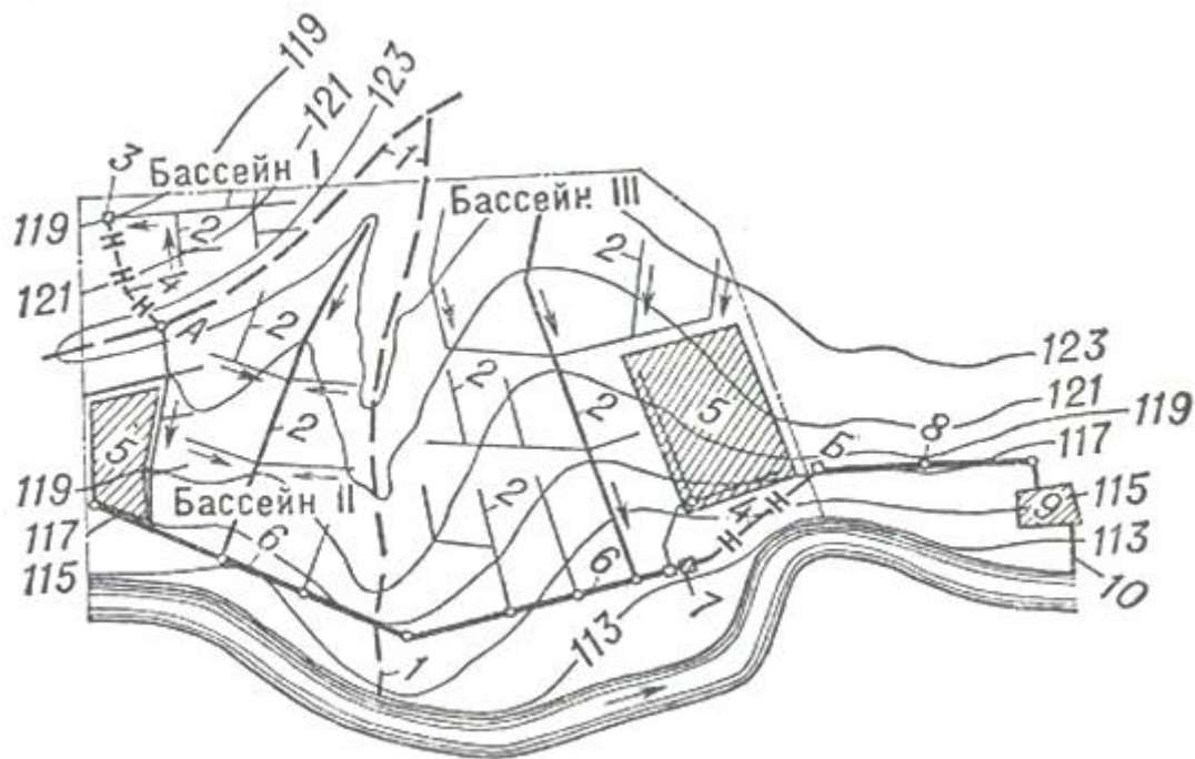
Rasm. 10. Turar joy punkti kanalizatsiya tizimining umumiy sxemasi va asosiy inshootlari:
