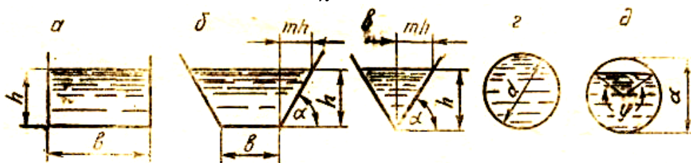
Ho'llangan perimetrda doir chizma.
