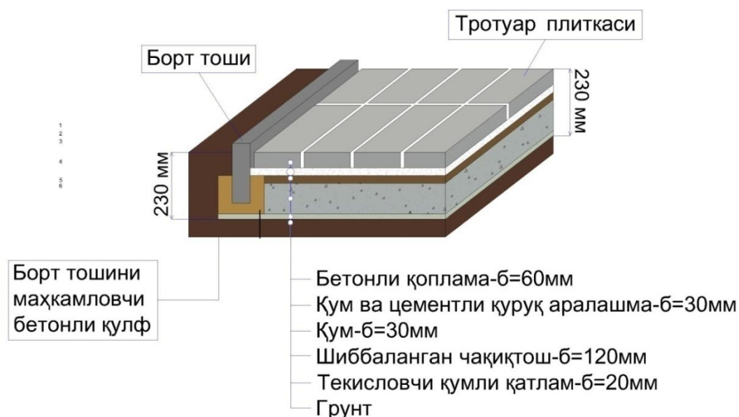
3.14-расм. Йўлакларнинг конструктив тузилиши
