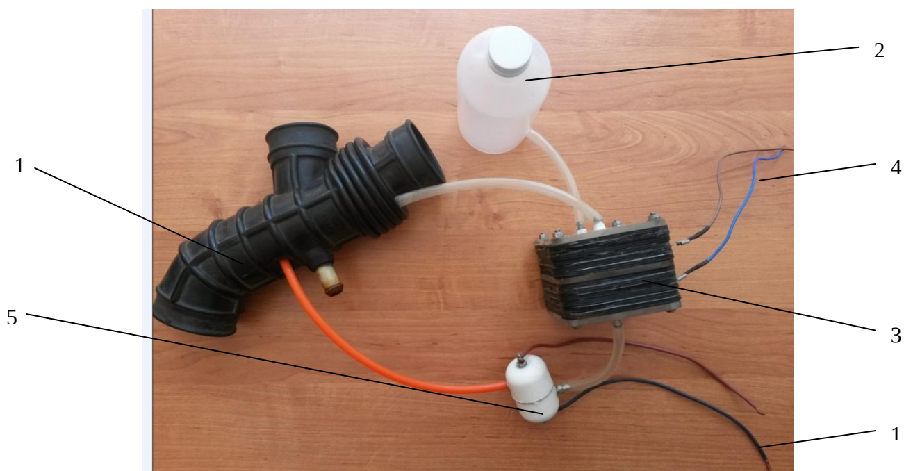
33- rasm. “Neksiya” avtomobili uchun yasalgan vodorod generatori.
