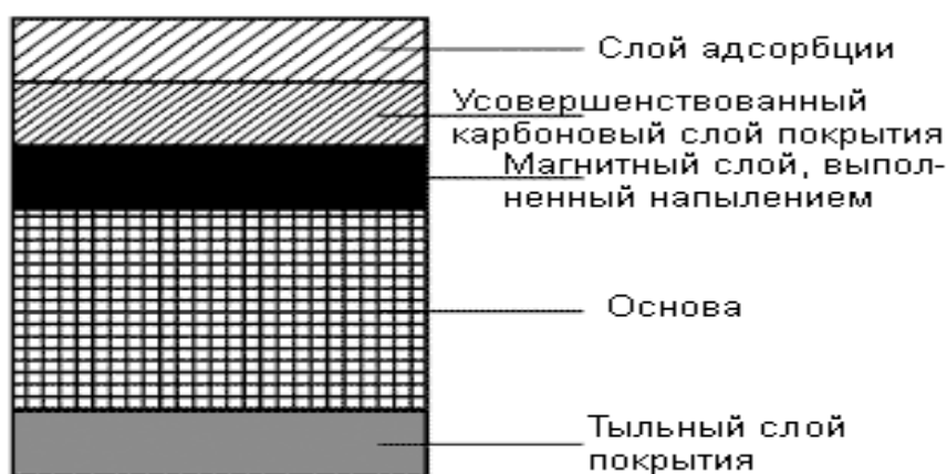
Рис. 2.3.. Структура магнитной ленты
