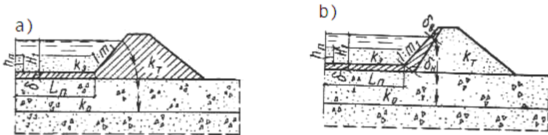
5.11 — rasm. Cheklanmagan qalinlikda suv o'tkazuvchi zamindagi bir qavatli ekranni filtratsiya hisobi sxemasi.
