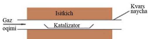
21- расм. Фуллерен ва нанонайчаларни бугдан кимёвий чўктириш йўли билан оловчи қурилма схемаси
