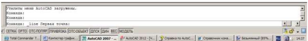
2.3-rasm. AutoCAD grafik dasturida to'g'ri chiziqli chizish amali bajarilayotganda xosil bo'ladigan yozuv.
