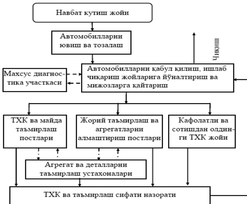
4.1-расм. АСКларида автосервисни ташкил қилишнинг технологик жараёни.
