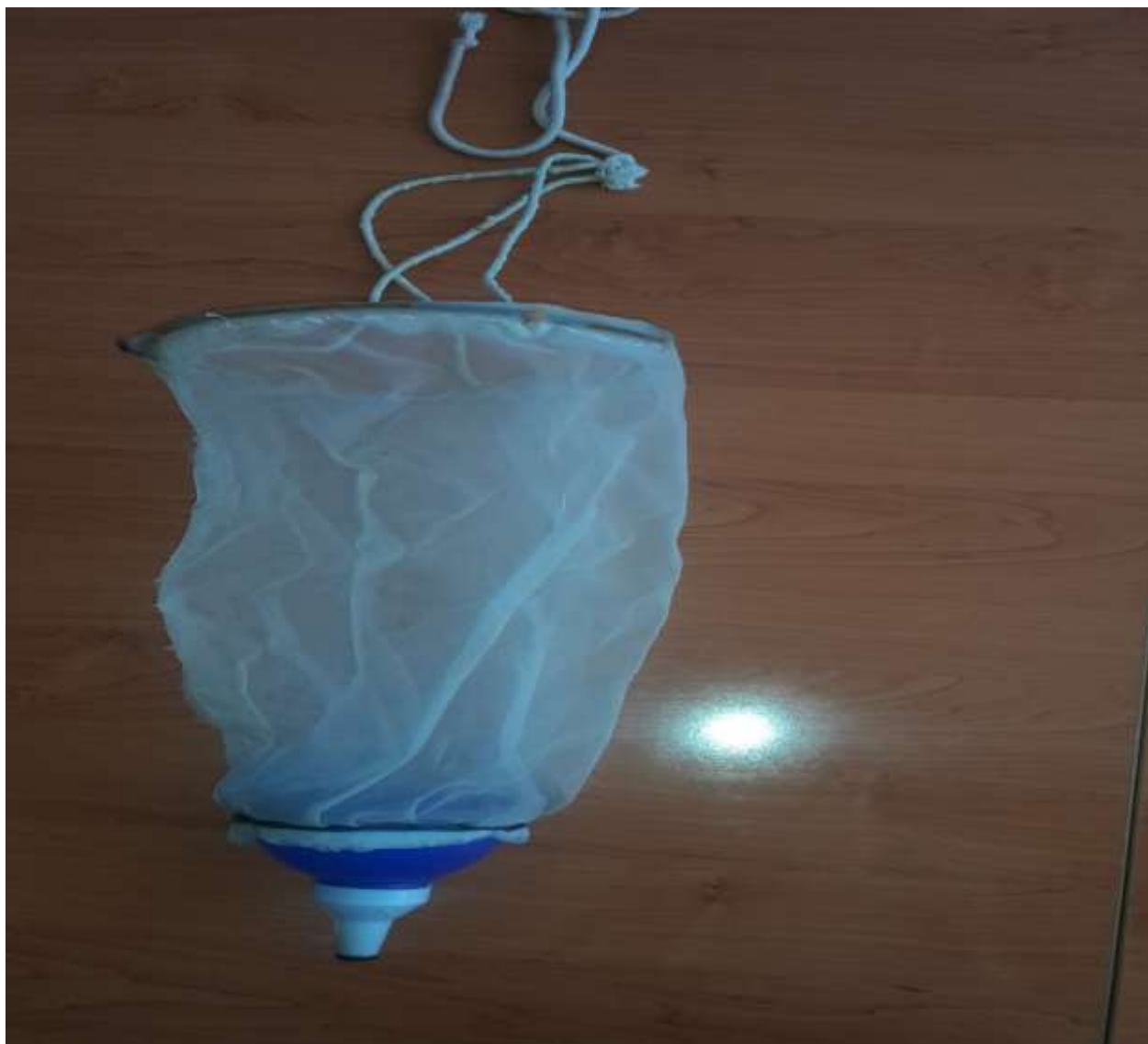
1-rasm plangtonlarni yig'ish uchun mo'jallangan to'r
