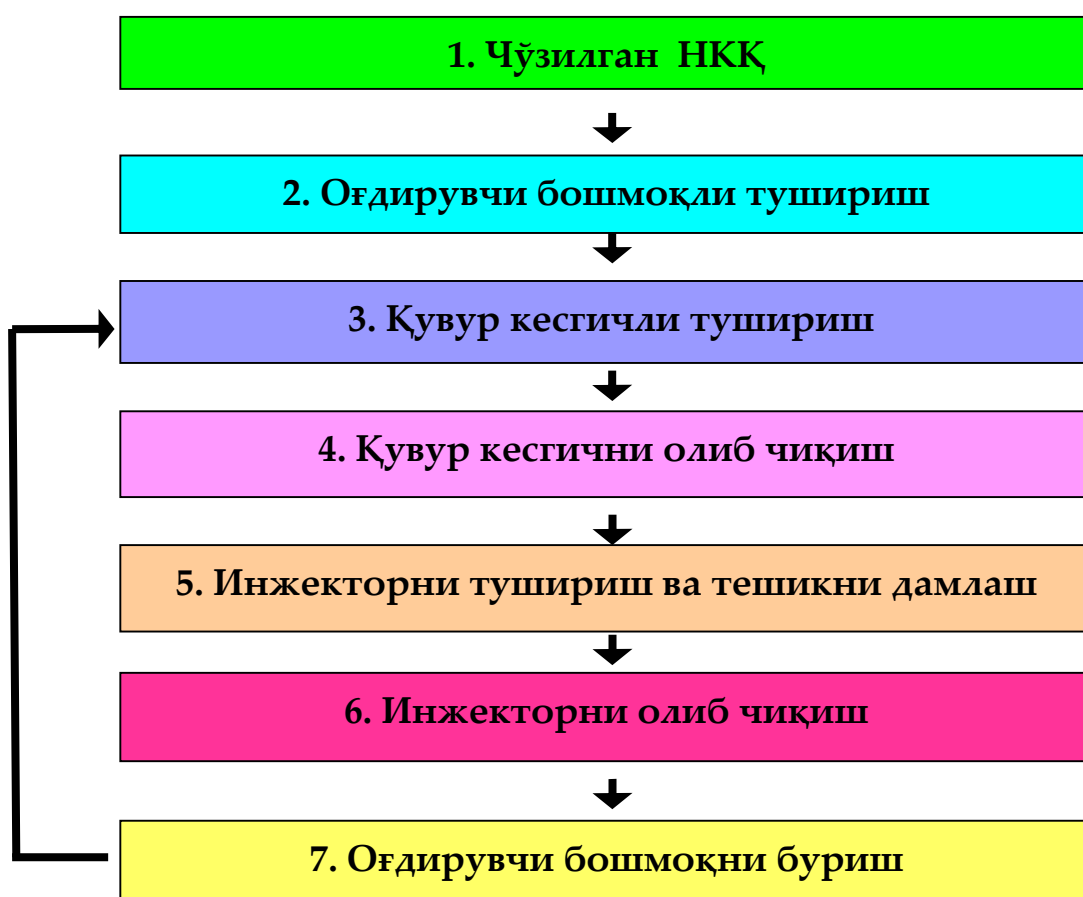
2.2-расм. Радиал қудуқни бурғилаш жараёнини олиб бориш тартиби
