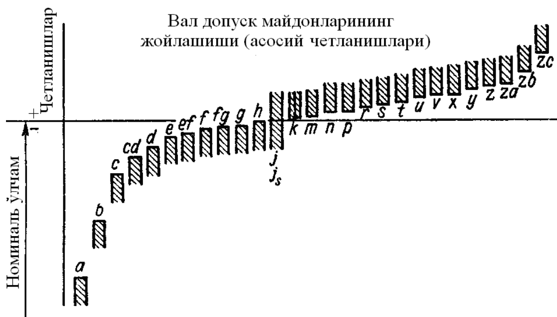
1-рasm. Teshik va val joizlik maydonlarining asosiy chetlanishlar qatori
