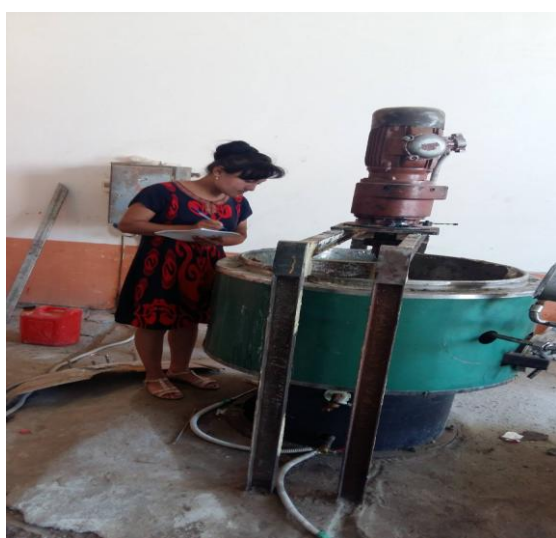
14-расм . Аралаштиргичли буғли қозон конструкцияси
