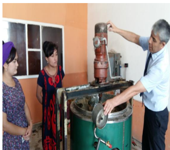
14-расм . Аралаштиргичли буғли қозон конструкцияси
