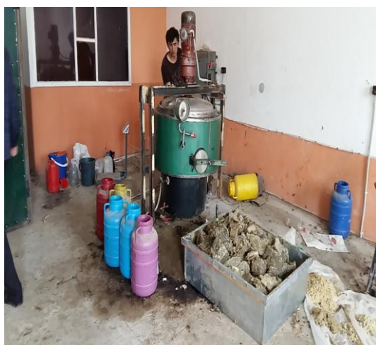
14-расм . Аралаштиргичли буғли қозон конструкцияси
