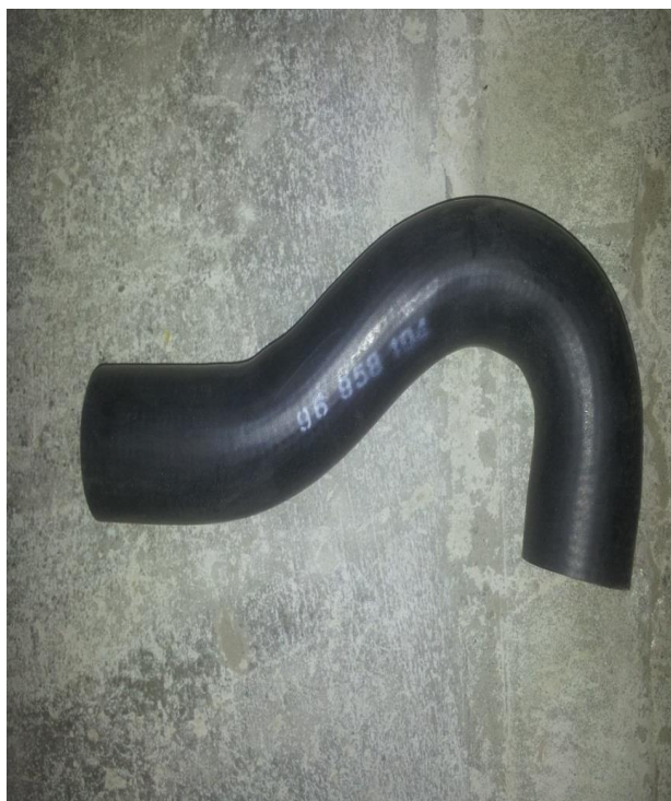
1-rasm. Kobalt avtomobili uchun ABS asosida ishlab chiqarilgan sovutish trubkasi.
