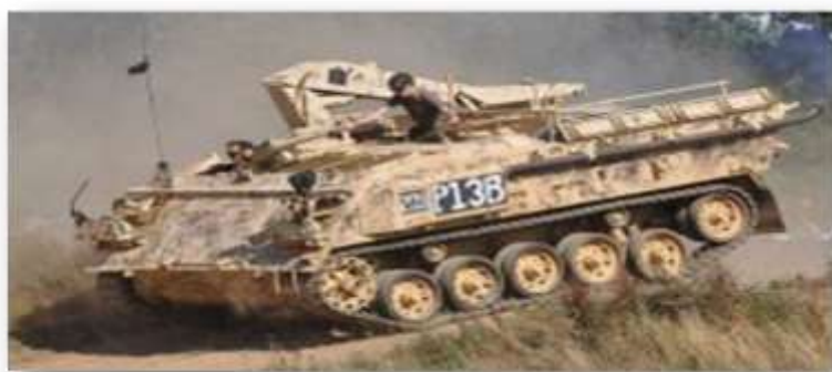
Рис.9 Бронированная ремонтно-эвакуационная машина FV434
